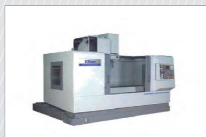
Machining Center (VX 400) : 3台。 Maker : WIA Size : 800 x 460 x 520
