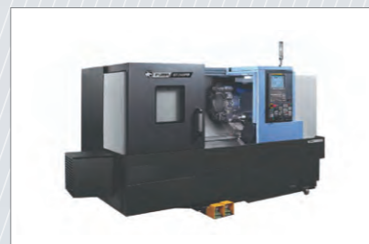
CNC 搁板 PUMA GT2100M : 1台。 Maker : DOOSAN Size : \Phi 300 x 513
