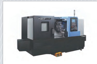
CNC 선반 PUMA GT2100M : 1대 Maker : DOOSAN Size : \Phi 300 x 513
